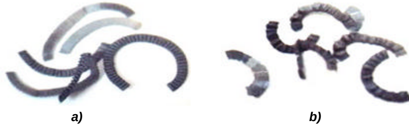
Fig. 8. Aschii la prelucrarea otelului Armco: a) la aschierea obisnuita; b) la aschierea cu vibratii.
