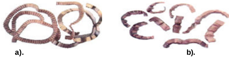
Fig. 9. Aschii la prelucrarea cuprului OFHC: a). – aschiere obisnuita; b). – aschiere cu vibratii.
